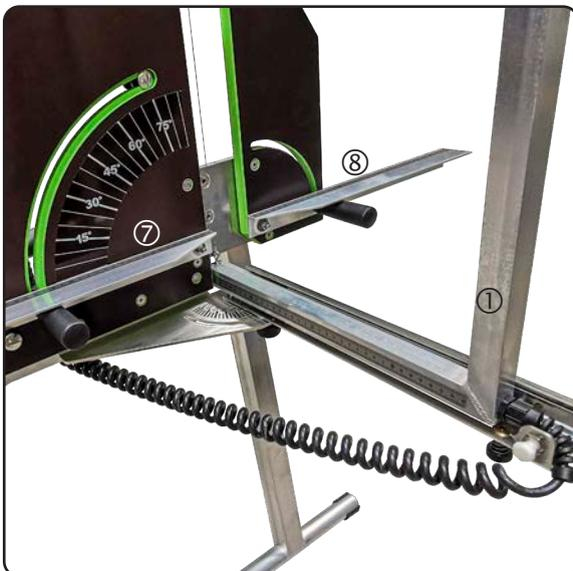
Den Hauptschneidebügel ① aus seiner Ruheposition bewegen und an der 90°-Position festziehen. Beide Auflegewinkel ⑦ ⑧ in die gewünschte Position umschwenken.
