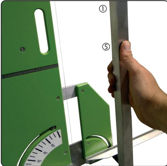
Betätigen Sie den roten Ein-/Aus-Taster ⑤ am Schneidebügel ① mit dem rechten Daumen, um den Schneidedraht zu erhitzen. Halten Sie mit der linken Hand das Schneidgut. Sie können nun durch bewegen des Schneidebügels handelsübliche Schaumpolystyrolplatten schneiden.
