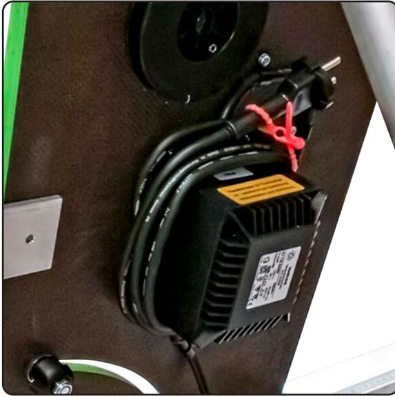
Schliessen Sie die STYcutter 1310 an einen üblichen 220V Anschluss an.
