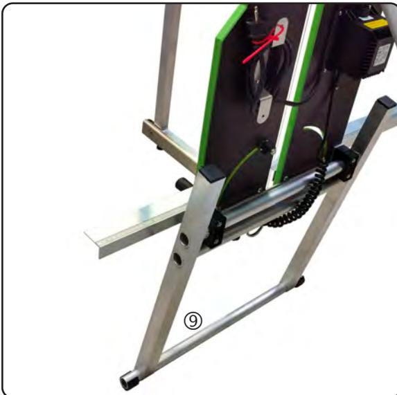
Stellen Sie sich nun hinter das Gerät und schwenken den Hauptstandfuß ⑨ nach unten und dann weiter nach vorn, während sie die Maschine anheben. Unterstützen Sie die Aufstellbewegung, indem Sie einen Fuß auf die untere Querverstrebung des Hauptstandfußes stellen. Der Hauptfuß-Aufstellvorgang ist beendet, wenn er an den beiden, am unteren Grundplattenrand angebrachten Aluminium-Platten anschlägt. Lehnen Sie Ihre STYcutter1310RW nun kippstabil gegen eine Wand.
